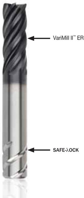
Die patentierte VariMill II™ ER-Ausführung mit **ungleicher Schneidreihenteilung** und einzigartiger Kerngeometrie für eine Bearbeitung ohne Rattern ermöglicht das Fräsen von Nuten in Titan von bis zu 1 x D.
